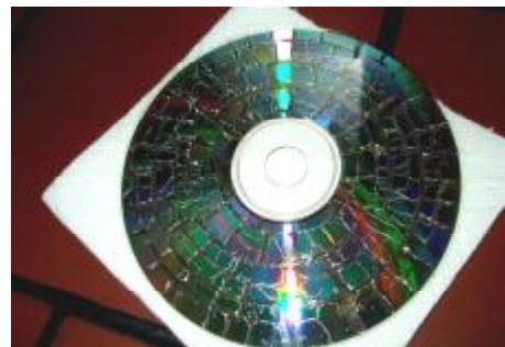
So sieht eine CD aus, nachdem sie der Bestrahlung mit Mikrowellen ausgesetzt war
